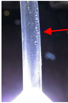
チューブ入口付近の結露
